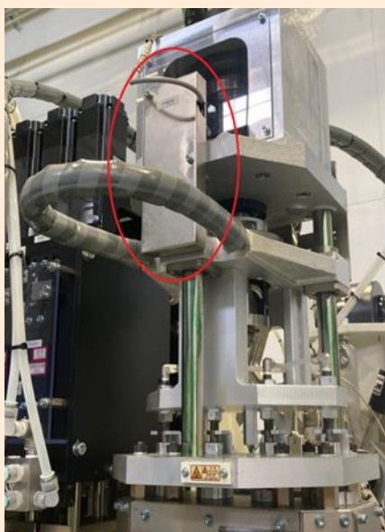
写真1：パリコン正面上部 (赤枠内-ポテンショメータカバー)
